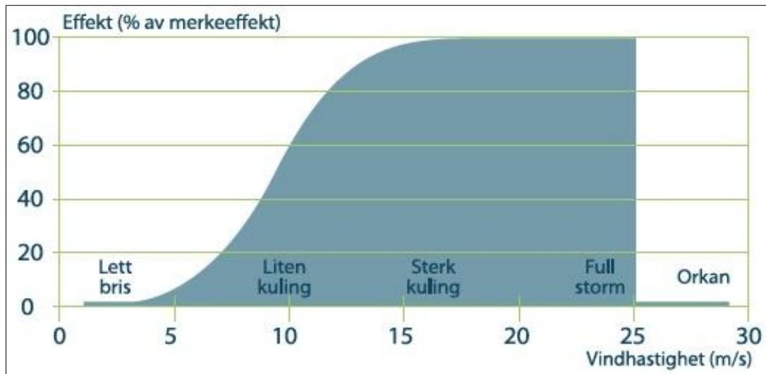
Figur 2: Normalisert effektkurve for en vindturbin
