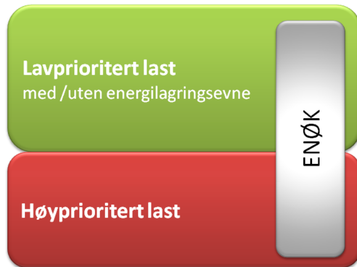
Figur 13 Lastfordeling i en bygning
