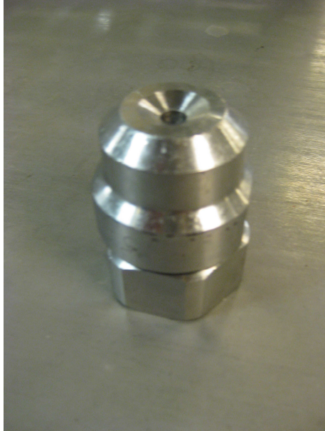
Figur 3.7. Bildet viser ei dyse til forstøving av konsentrat ved spraytørking av melkepulver. Foto: B. Pettersen, 2011.
