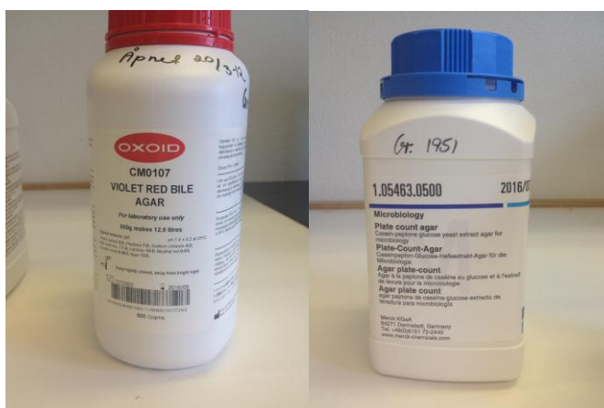
Figur 11: Til venstre; agaren som ble benyttet til analyse av koliforme, Violet Red Bile Agar. Til høyere; agaren som ble benyttet til analyse av totalkim, Plate Count Agar
