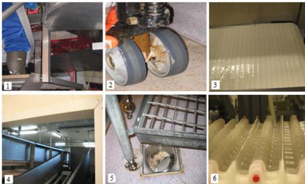
Figur 2 Eksempler på kilder til kontaminering i et produksjonsmiljø 1) Blodsøl 2) Truck-hjul 3) Transportbånd 4) Kondens over transportbånd 5) Urene sluk og gulv 6) Leddet transportbånd
