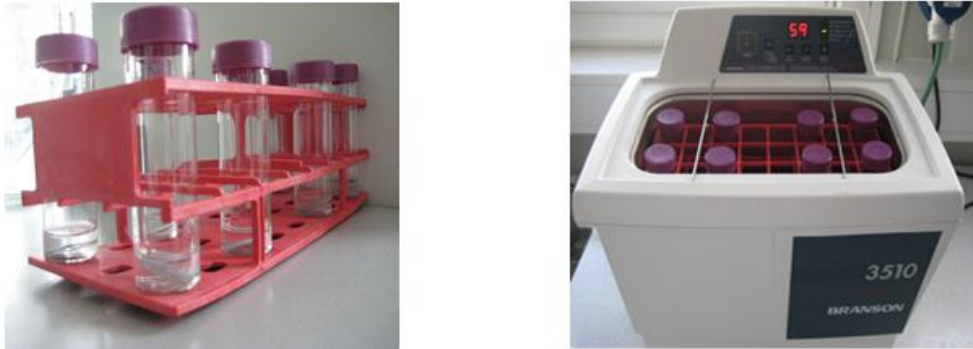
Figur 9 Stålkuponger i sterile glassrør med 6 ml degasset sdH 2 O (venstre). Ultralyd bad (40 kHz, BRANSON 3510, Branson Ultrasonic Corporation, USA) (høyre).
