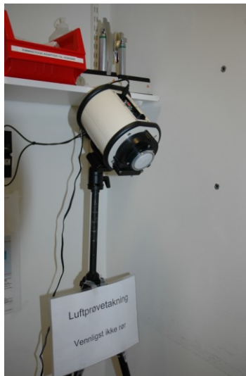
Figur 2.1.1. SASS 3100 filter-lufthøster (Bilde fra AHUS)
