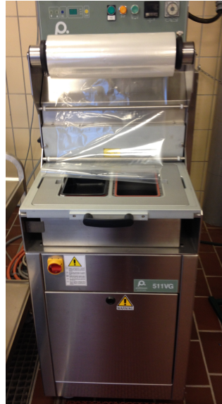
Figur 11. Skålpakkemaskin benyttet i dette forsøket for å lage MAP.
