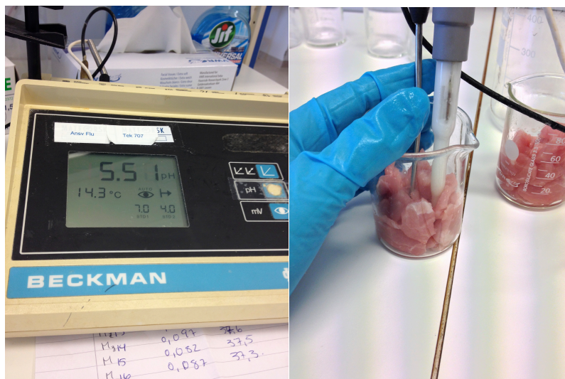
Figur 18. pH-målinger. Til venstre: pH-meter benyttet i dette forsøket. Til høyre: eksempel på pH-måling.
