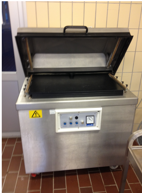
Figur 13. Kammermaskin benyttet i dette forsøket for å lage vakuumposer.
