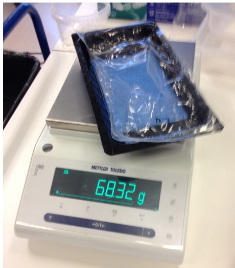
Figur 19. Eksempel på veiing av skinpack og emitter for å beregne drypptap.
