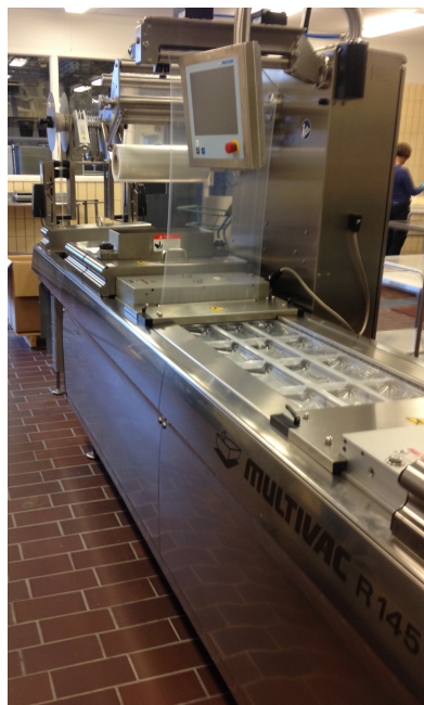
Figur 12. Termoformer (dyptrekker) benyttet i dette forsøket for å lage skinpack.
