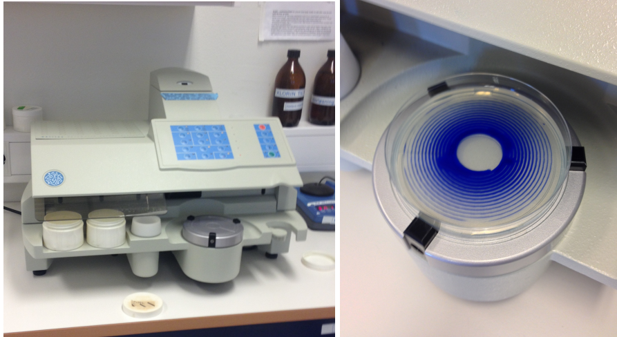
Figur 17. WASP, en automatisk spiralutplater, som sår fortynninger automatisk ut i en spiral og koloniene kan telles ved en tellemaskin. Til venstre: WASPen og til høyre: hvordan spiral utsåingen ser ut på agarskålen.
