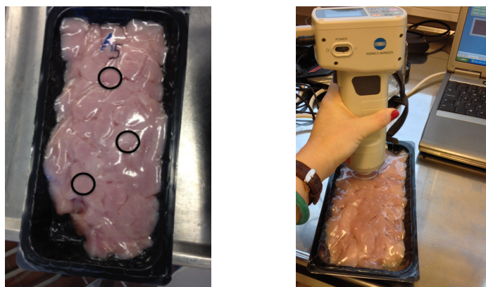
Figur 15: Eksempel på Minolta fargemåling av emballert svinekjøtt. Til venstre: tre tilfeldige punkter. Til høyre: Minolta CR-400 fargemåler.
