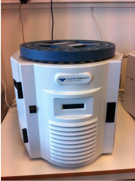
Bilde 3: Teledyne Tekmar HT3 headspace autosampler
