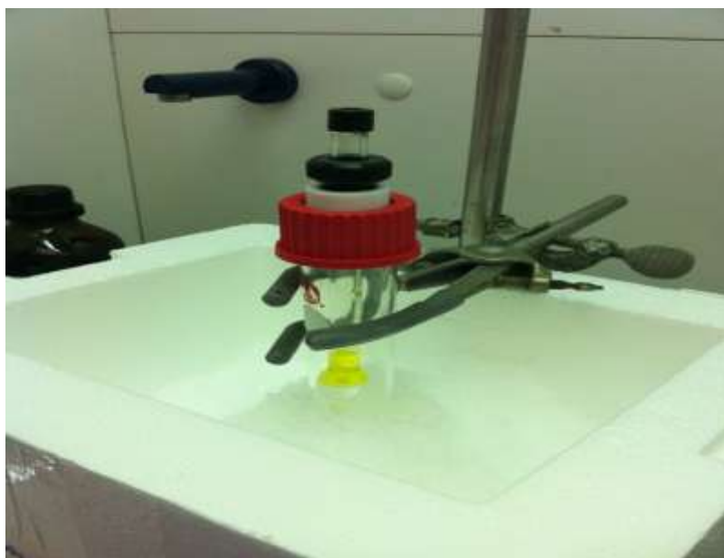
Figur 3.3: Den brukte diazometan generator for derivatisering av karboksylsyrer.
