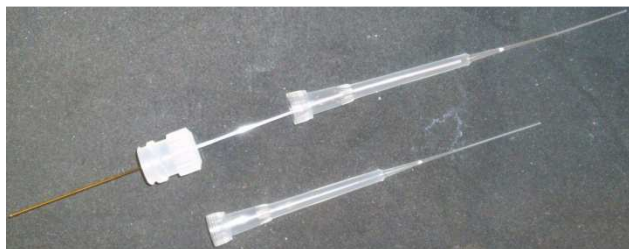
Figur 5.10: Tillaging av kolonne, applisering av kolonne materiale i micropipette spisser (Foto: Lian, 2012).
