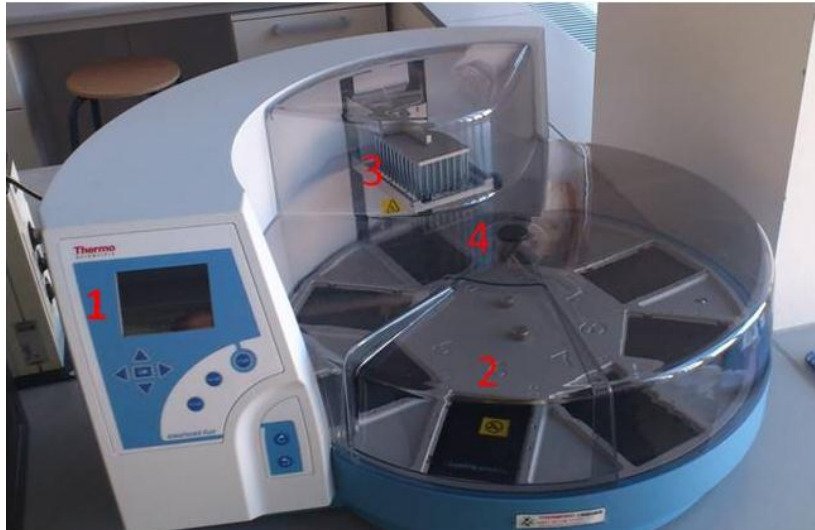
Figur 1.8 King Fisher FLEX ekstraksjonsrobot. Roboten kan ekstrahere DNA fra opp til 96 prøver á gangen. Kort beskrevet styres roboten med knapper og LCD skjerm til venstre på bildet (1). Hjulet (farget grått) er basen hvor de ulike platene plasseres, og dette beveger på seg ettersom prosessen går (2). Roboten har et deksel, som hindrer kontaminering under kjøring, ved 2-tallet på figuren er ladestasjonen, hvor alle plater settes inn og tas ut. Samling av korte ”stenger”, hevet over basen er magnetene. Magneten holder samme posisjon under hele prosessen (3). I tillegg finnes en beskyttelses plate under magnetene som er med å hindre kontaminering. Plattformen under magnetene har en varmeblokk (4). Under ekstraksjon vil hjulet gå rundt, og ulike buffere plasseres under magnetene i riktig rekkefølge. Foto Fredrik Jordhøy
