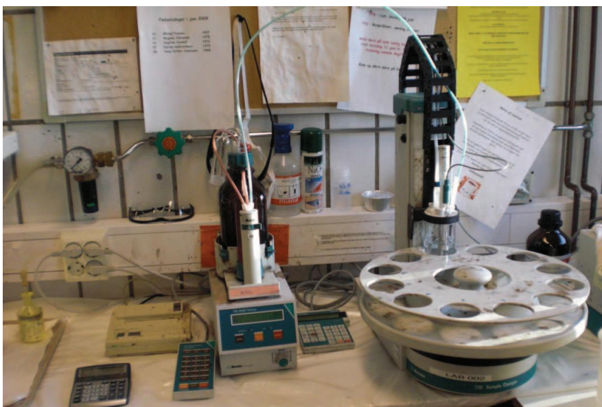
Figur 9: Titrator brukt til titrering av salt (klorid)innhold (foto: Line Agersborg).
