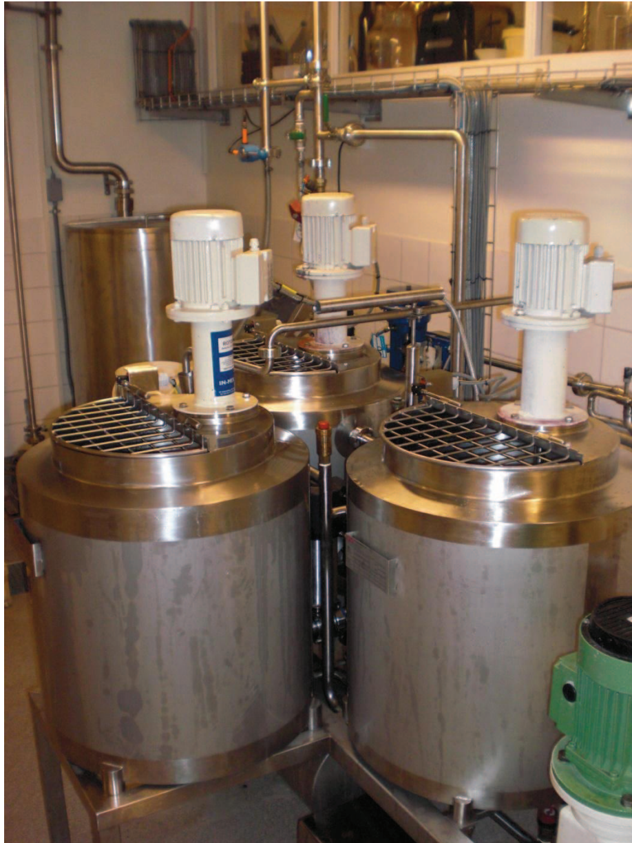
Figur 5: Fra pilotanlegget for framstilling av margarin. Tanker til forvarming av olje (foto: Line Agersborg).
