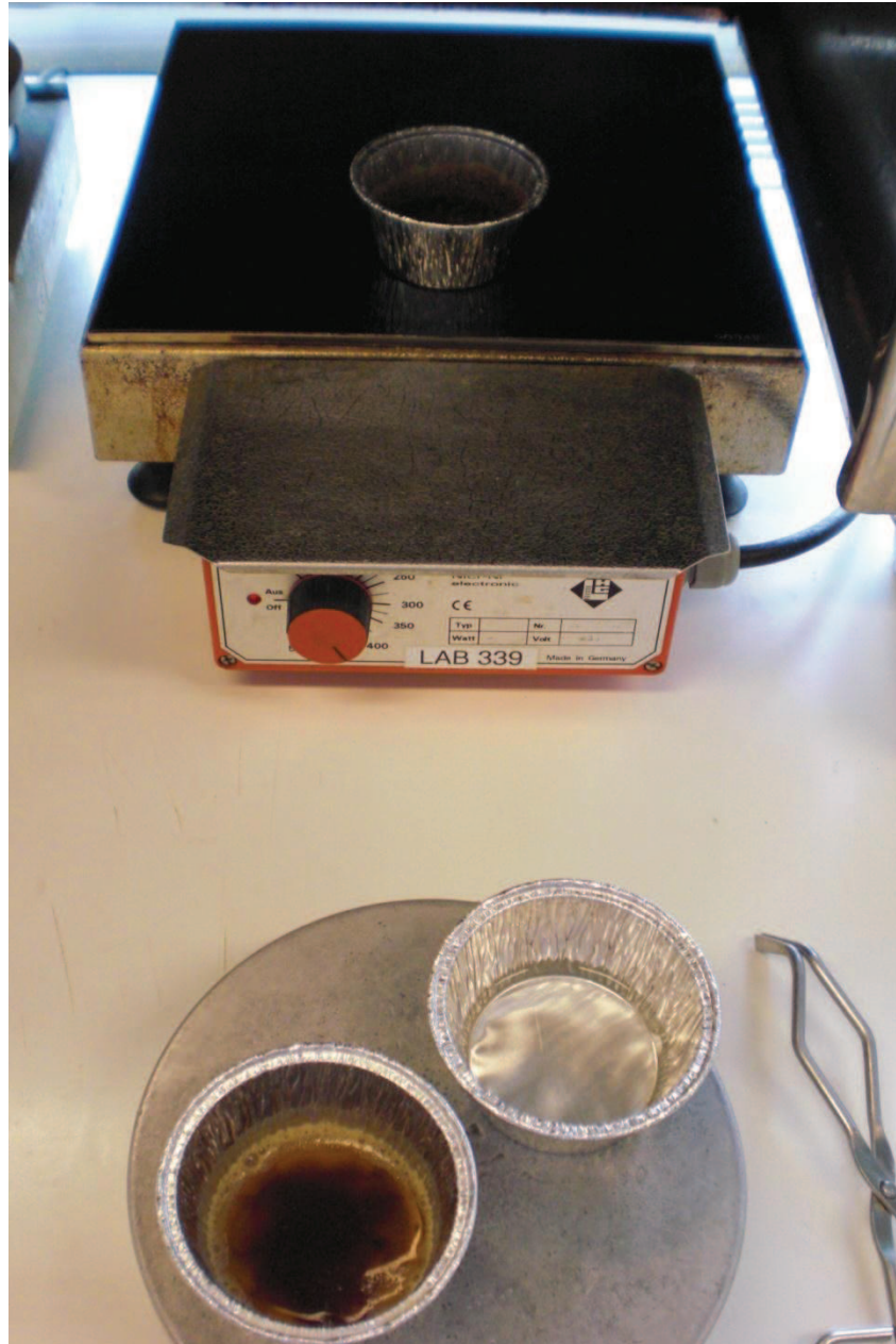
Figur 10: Utstyr for sjekk av vanninnhold. Prøven i forkant er ferdig varmebehandlet (foto: Line Agersborg).
