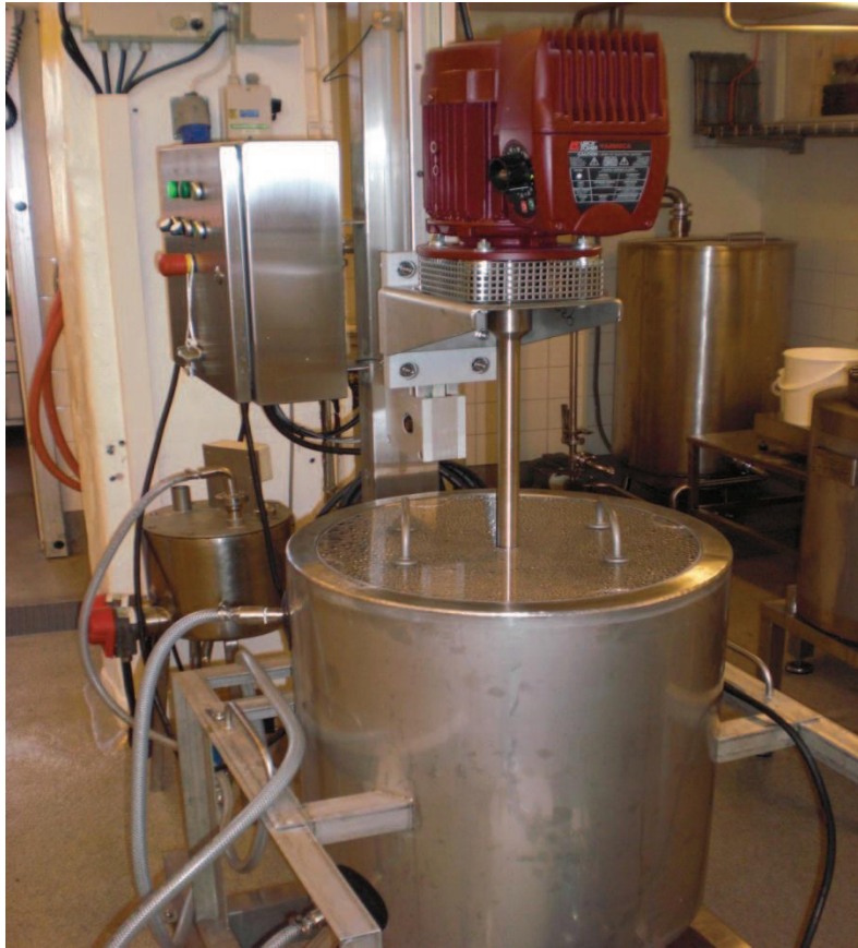
Figur 6: Fra Mills' pilotanlegg: tank med røreverk for blanding av pektin (foto: Line Agersborg).
