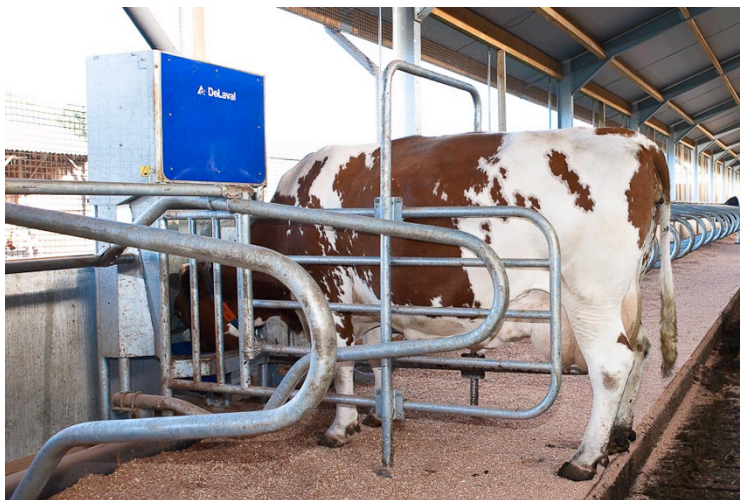
Figur 4 Kraftfôrstasjon for melkeku(DeLaval 2012)
