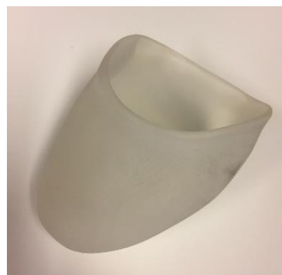
Figur 8-21. Prøvehylse nr. 3, 3D-printet med en MJ-printer.
