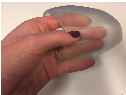
Figur 9-14. Man kan se fingrene gjennom prøvehylse nr. 2
