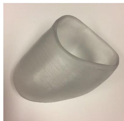
Figur 8-20. Prøvehylse nr. 2, 3D-printet med en SLA-printer.
