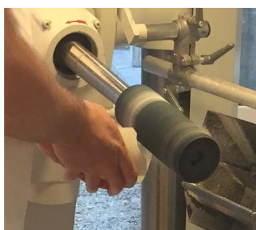
Figur 9-9. Prøvehylsen slipes for at pasienten skal kunne føre stumpen ned i den
