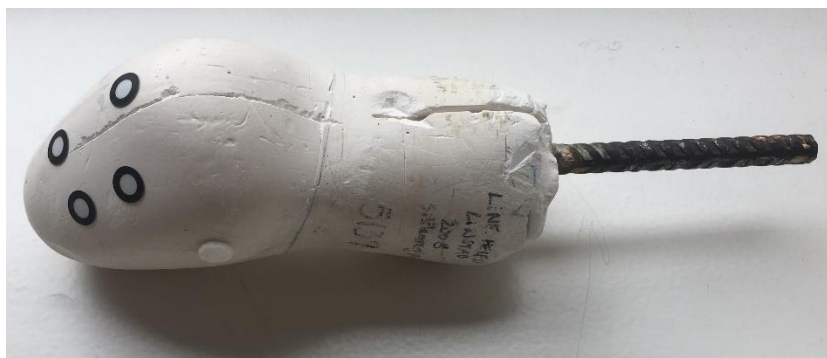
Figur 9-20. Test-pasientens gipspositiv, klar til å bli 3D-skannet. De svarte sirklene med refleks i midten er referansepunkter. Det er plassert hvite filtknøtter ved kondylene.
