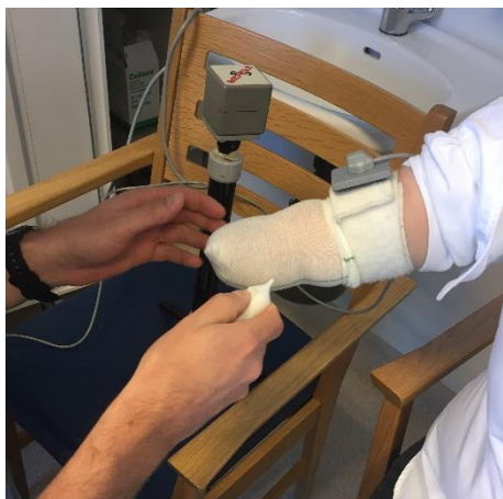
Figur 9-1. 3D-skanning utføres på en pasient med transradial amputasjon. Tuppen av Tracer Pen markerer viktige punkter på stumpen. En sender er plassert på stolen ved siden av pasienten.
