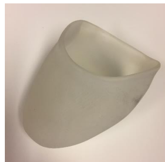
Figur 9-7. MJ-printet prøvehylse – Prøvehylse nr. 3
