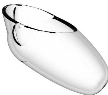
Figur 8-16. Test-prøvehylse designet i SolidWorks for estimering av tid ved 3D-printing med forskjellige metoder.
