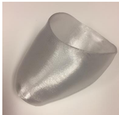
Figur 8-19. Prøvehylse nr. 1, 3D-printet med en FDM-printer.
